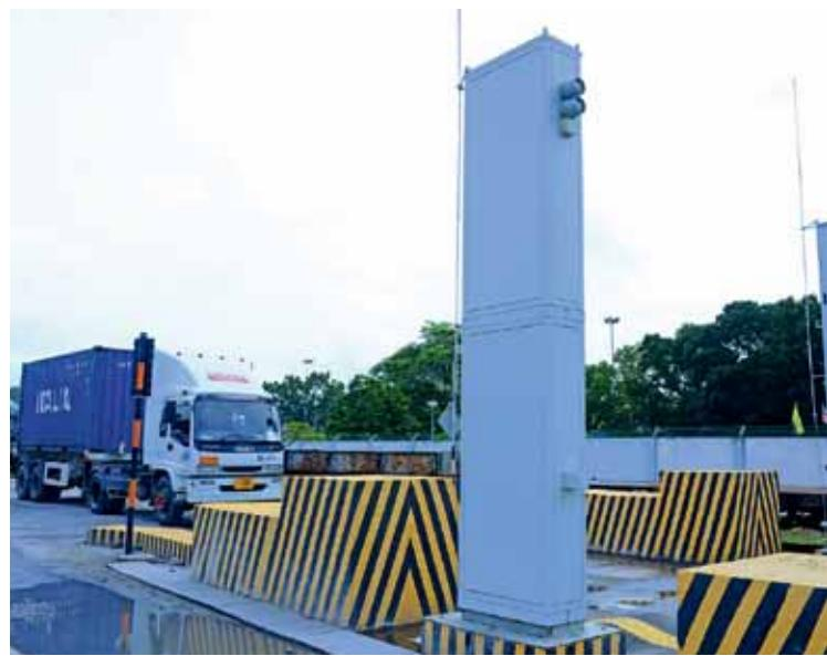
6 门式辐射监测器在边界处实时地探测辐射，不会中断正常出口作业。此外，摄像机同时识别集装箱，捕捉卡车图像及金属牌和集装箱数量等详细信息。测量结果和图像被传输到中央警报站作进一步检查。
