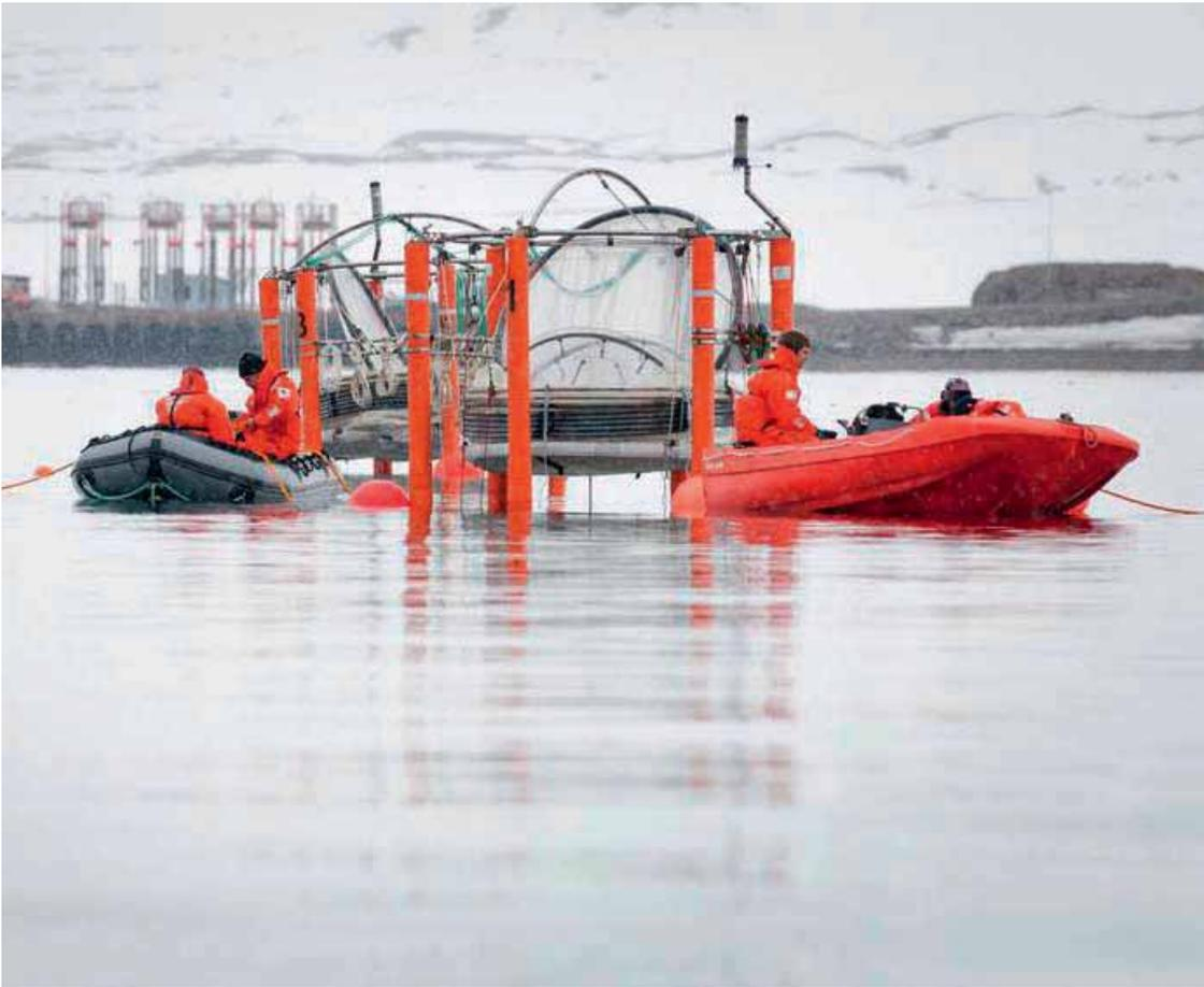
可以在称作中型实验生态系的浮动或海底张拉结构中实施放射性示踪剂研究。这种宝贵的实验工具使得能够在结合实验室和现场工作两方面优势的受控条件下研究自然环境。（照片由尼克·库兵提供）
