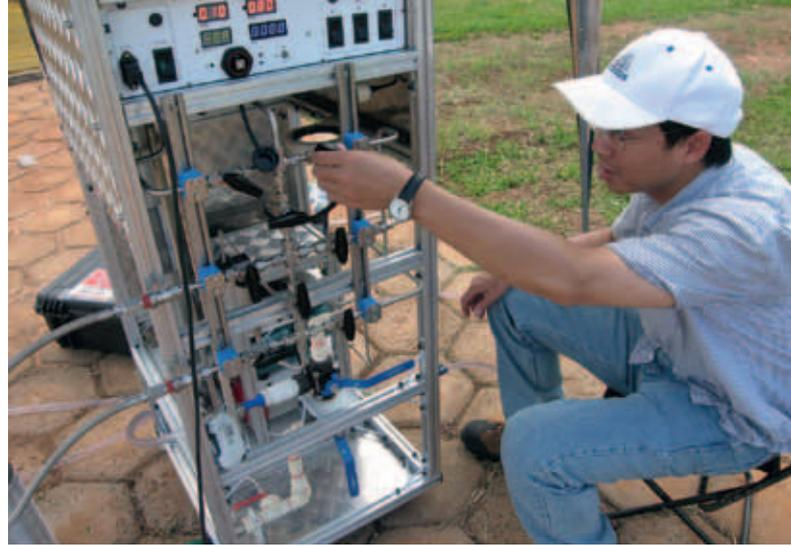
٤ وتساعد التقنيات النظرية في فهم حركة المياه السطحية والتفاعل مع المياه الجوفية وتسريبات مياه السدود وأثر تغير المناخ في تنمية الموارد المائية وإدارتها. ويظهر في الصورة جهاز أخذ عينات لقياس الغازات الحاملة والنظائر في المياه الجوفية.
