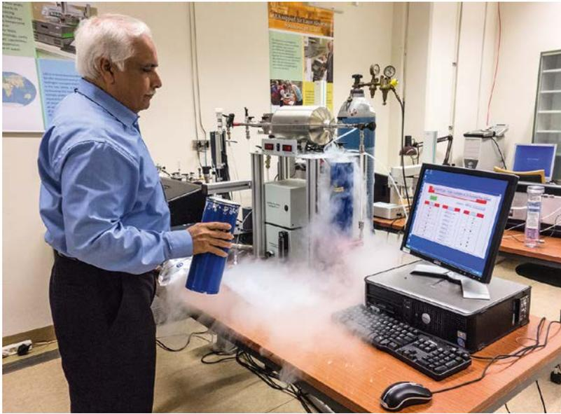
**5** Una de las formas en que los científicos pueden medir la composición isotópica del carbono inorgánico disuelto en el agua es mediante la espectrometría de absorción con láser. Como su nombre lo indica, un instrumento láser es ajustado con precisión para determinar las concentraciones de  $^{13}\text{C}$  y  $^{12}\text{C}$  en una muestra de ensayo de  $\text{CO}_2$  preparada.
