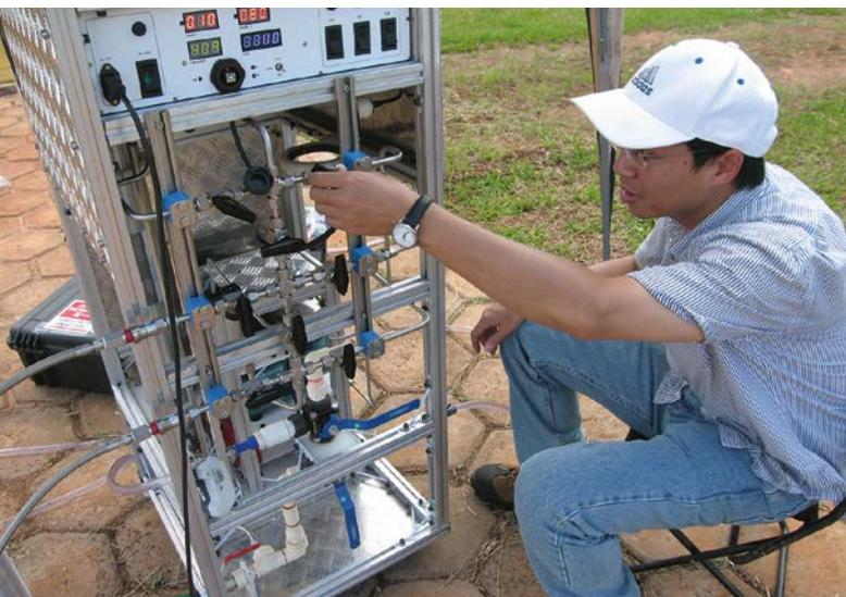
**3** Les techniques isotopiques peuvent déterminer l'origine, l'âge et le taux de renouvellement des eaux souterraines ainsi que tout risque de contamination éventuel. Elles permettent de cartographier rapidement et avec fiabilité les ressources non renouvelables en eaux souterraines, qui sont pour la plupart des aquifères transfrontières. Des isotopes comme le krypton 81 sont utilisés pour la datation des eaux souterraines très anciennes d'aquifères profonds.
