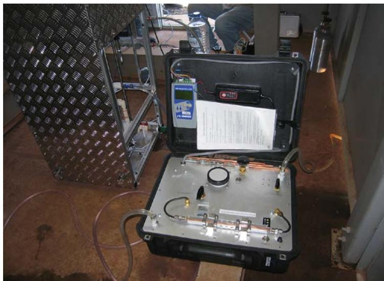
**4** Les techniques isotopiques permettent de comprendre le mouvement des eaux de surface et leur interaction avec les eaux souterraines, les fuites de barrages, ainsi que l'impact des changements climatiques sur la valorisation et la gestion des ressources en eau. La photo montre un dispositif d'échantillonnage pour mesurer la teneur des eaux souterraines en gaz rares et en isotopes.
