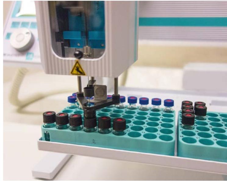
6 La mesure des isotopes stables de l'eau au moyen de la spectrométrie par absorption laser est encore plus efficace si l'on utilise un auto-échantillonneur. Automatiser les processus se traduit par un gain de temps et d'effort pour les scientifiques mais aussi par une plus grande cohérence de la procédure dans le cas d'une technique très sensible.
