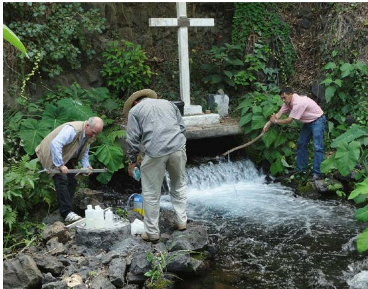
**2** L'eau est constituée d'isotopes de l'hydrogène et de l'oxygène, répartis le long du cycle hydrologique. Chaque goutte d'eau, en se déplaçant, entraîne de petits changements notables et quantifiables dans la relative abondance des différents isotopes. L'eau dans des environnements différents révèle des empreintes isotopiques propres qui permettent de la caractériser de manière distincte. Il est possible de déterminer l'origine de l'eau et de calculer son âge dans le système hydrogéologique.
