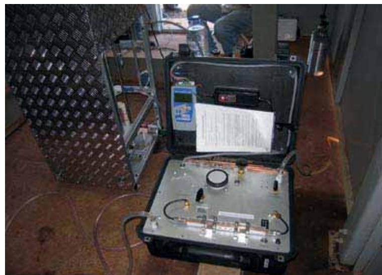
4 同位素技术有助于了解地表水运动及其与地下水的相互作用，水坝的泄漏情况，以及气候变化对水资源开发和管理的影响。照片是用于测量地下水中的惰性气体和同位素的取样装置。
