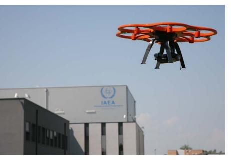
Vehículo aéreo no tripulado diseñado por el NSIL para tareas de monitorización a distancia de la radiación ambiental. (Fotografía: Steve Thachet, OIEA)
