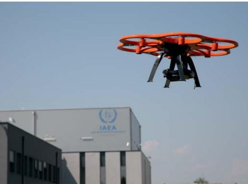
Разработанный ЛЯНП беспилотный летательный аппарат для проведения дистанционного радиационного мониторинга.
