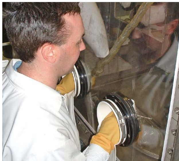
Cajón de clasificación para la segregación de los desechos (Fotografía: Downreay Site Restoration Ltd y Autoridad de Clausura de Instalaciones Nucleares (NDA) del Reino Unido)
