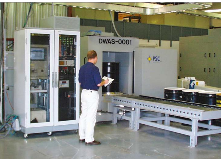
El sistema PANDDA™ (Passive Active Neutron Differential Die-Away) de espectroscopia de rayos gamma de alta resolución para el control de los bidones. (Fotografía: Pajarito Scientific Corporation (Estados Unidos de América))
