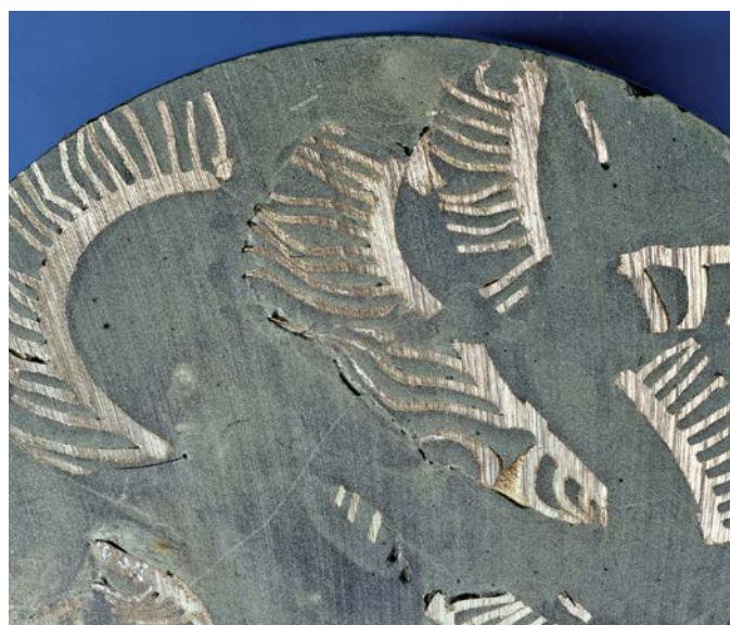
Vainas de combustible de magnox encapsuladas en cemento en Sellafield (Fotografía: Sellafield Ltd (Reino Unido))
