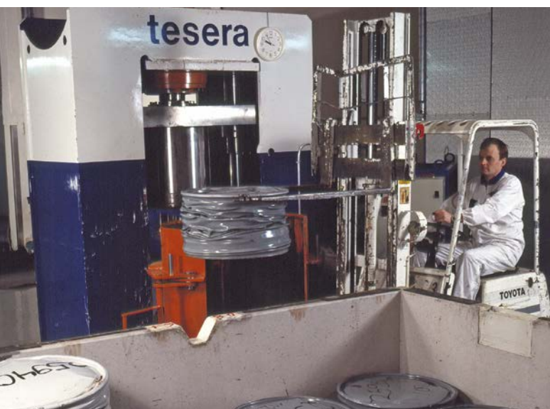
Supercompactador de bidones de desechos sólidos (Fotografía: Teollisuuden Voima Oyj (TVO) (Finlandia))
