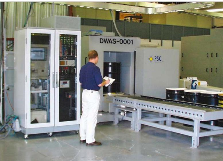
*Passive Active Neutron Differential Die-Away System (PANDDATM), système de spectrométrie gamma de haute résolution pour le contrôle de fûts.*
