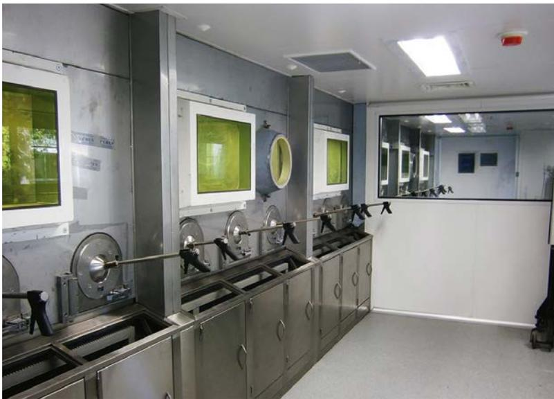
**7** Les nouvelles cellules chaudes de production de technétium 99m étaient conformes aux dispositions des bonnes pratiques de fabrication pertinentes. L'extérieur de la cellule était en acier inoxydable et les murs, le plancher et le plafond étaient conformes aux normes de propreté pharmaceutique établies.
