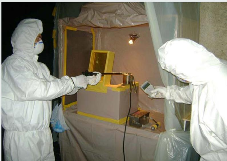
Verificación del nivel de radiactividad de una cápsula que contiene fuentes acondicionadas de cesio 137. (Fotografía: J. Balla/OIEA)
