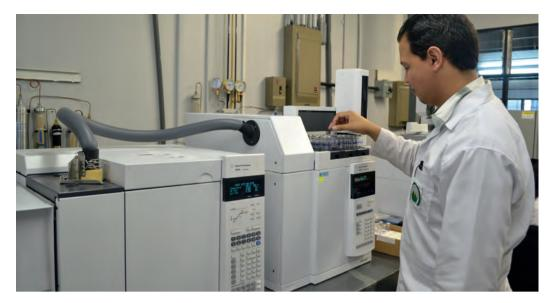
Analyse d'échantillons prélevés en champ à l'aide d'un chromatographe gazeux avec autoéchantillonneur d'espace de tête.
