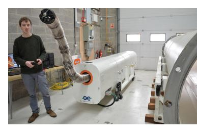
Un robot-serpent équipé d'une lame laser permet à l'équipe de déclassement d'accéder à des espaces confinés et dangereux.
