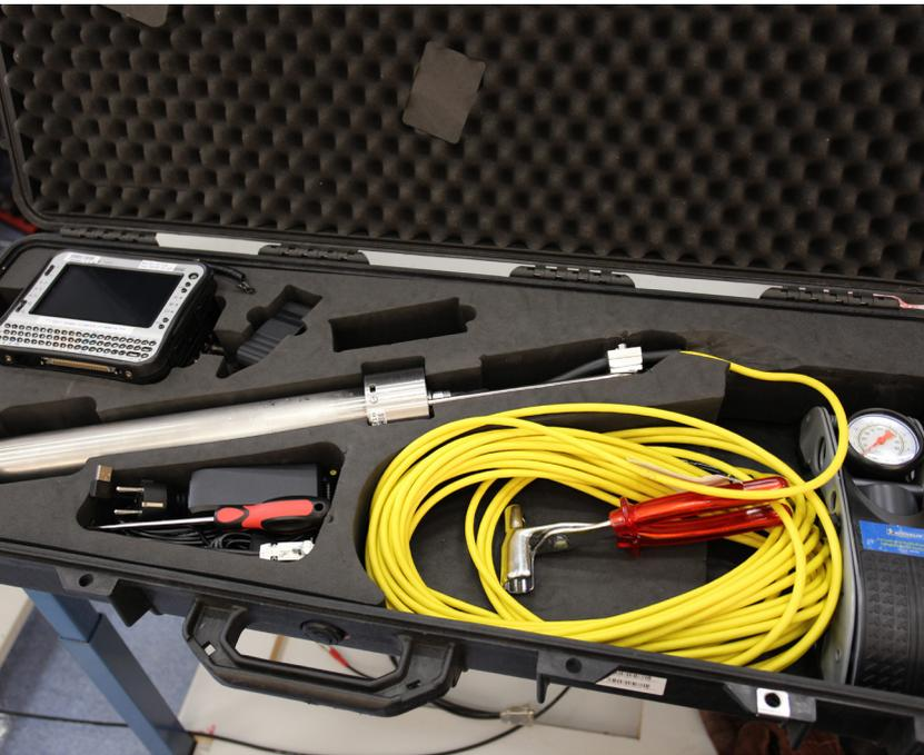
Le **testeur d'attributs des éléments irradiés**, par exemple, est constitué d'un détecteur de rayons gamma, petit (de la taille d'une petite pierre précieuse) mais sensible, enfermé dans un tube de protection. Plongé dans le bassin à combustible usé, il permet de mesurer les éléments qui y sont entreposés. Il est relié par des câbles à un analyseur qui reste sur le bord du bassin.
