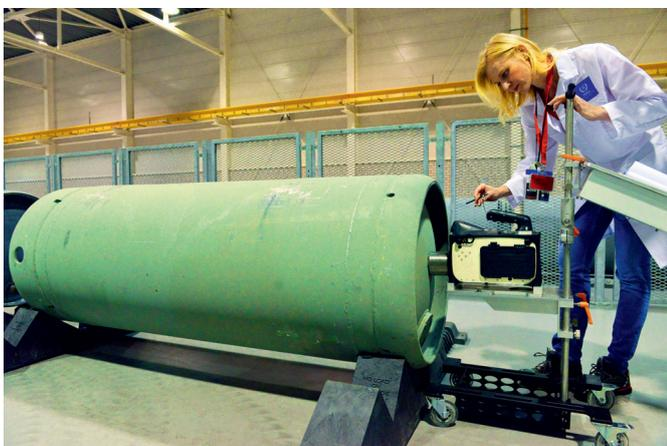
Une inspectrice des garanties de l'AIEA mesure l'uranium faiblement enrichi dans un cylindre du site d'enrichissement d'URENCO, à Almelo (Pays-Bas), en 2015.
