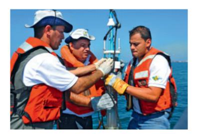
Un grupo de científicos sumerge un equipo de obtención de muestras testigo de sedimentos frente a las costas de Honduras, en 2009, para estudiar los efectos de la contaminación del agua mediante técnicas nucleares. Fotografía: OIEA
