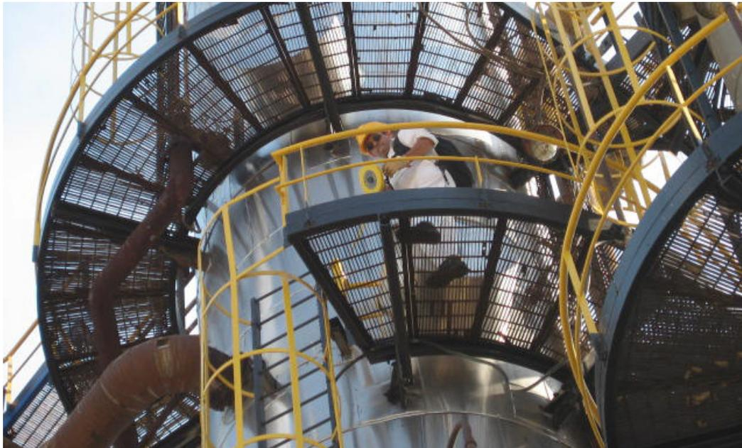
Dans une raffinerie marocaine, un spécialiste du CNESTEN effectue un balayage gamma dans une colonne de distillation à lit sous vide haute de 75 mètres.
