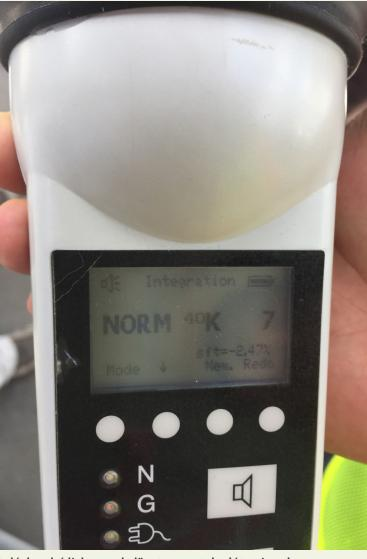
Un douanier procède à l'inspection secondaire d'un camion ayant déclenché l'alarme de l'instrument de détection de rayonnements du port. Le dispositif portatif confirme que le déclenchement de l'alarme est dû à des quantités insignifiantes de rayonnements naturels émis par du potassium 40, et non par des sources radioactives ou des matières nucléaires passées en contrebande.
